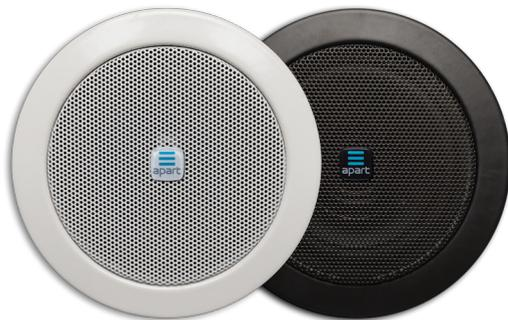
CM3Tは、Hi-Z / Lo-Z (100V / 70V / 16Ω) 対応で、スタイリッシュな小型スピーカーです。ダウンライトサイズにより、幅広いインテリアスタイルにマッチします。パウダールームやクロークなど、静かな場所でのアナウンスやBGMに最適です。フルメタルフレームとコーティング済みデュアルペーパーコーンを採用し、歪を抑えつつ耐湿性を高めています。またCM3Tは2つのスプリングクランプにより、簡単に素早い取り付けを実現しています。白と黒のカラーバリエーションがあります。
