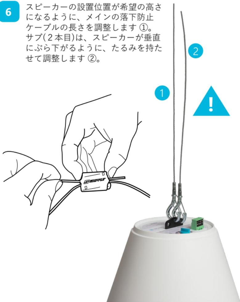
上図のようにボタンを押すことにより、ケーブル長の調整や解放をすることができます。長さを調整する際は、荷重が掛かったままの状態ではおこなわず、また、ロック金具からケーブルの余長が75mm以上出るようにしてください。
