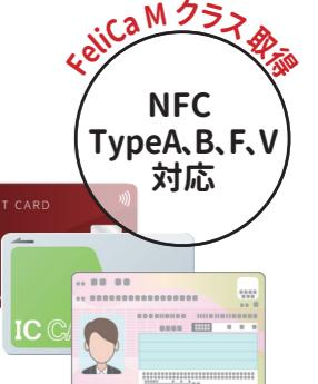
世界的に普及している TypeA に加え、マイナンバーカードや運転免許証・クレジットカードなど個人情報が多く含まれるカード類に利用される TypeB、そして交通系 IC カードや電子マネーに利用される TypeF (FeliCa) の規格に対応。NFC 検定試験の中でも基準の厳しい FeliCa リーダライタ RF 性能検定 M クラス※を取得しており、あらゆるシーンで活用できます。
