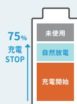
AC常時給電の際、バッテリー残量が75%に到達した時点で充電を停止し、満充電時のバッテリー負荷を軽減。
