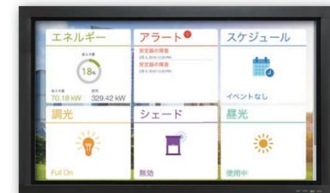
クアナム専用ソフトウェア「Quantum Vue」は、施設管理者が省エネ、快適性、生産性を最大化するために照明と自然光を最大限省エネ利用できるようにした集中制御システムです。ビル全体の照明を1ヶ所から簡単に設定、監視、分析、および報告することができます。
