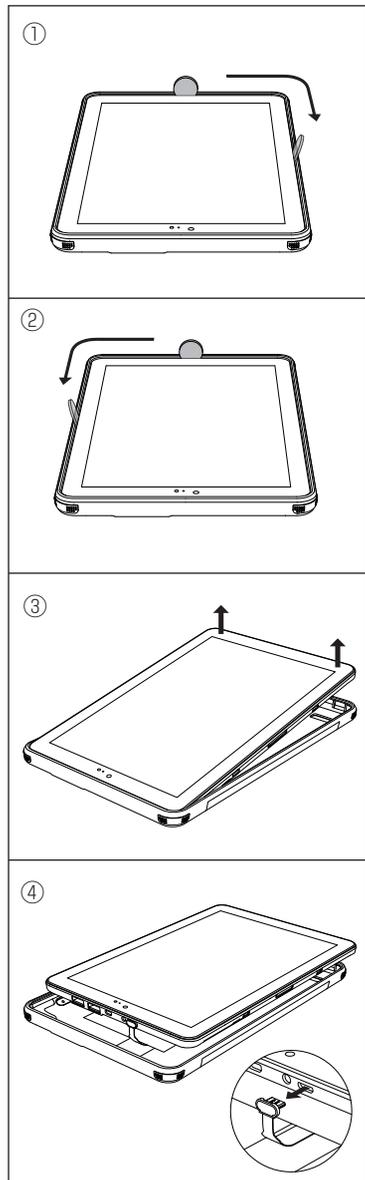
①本機からタブレットを取り外すときは、ギターのピックのような、樹脂でできた薄いへら状のものを用意して、タブレットのスピーカー開口部側の中央付近に差し込みます。差し込んだら外周に沿って右側に動かすとタブレットが本機から浮きます。
