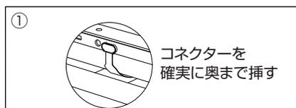
① 当社製対応タブレットを用意します。タブレットのMicroUSB端子に本機の電源供給コネクタを挿入します。
