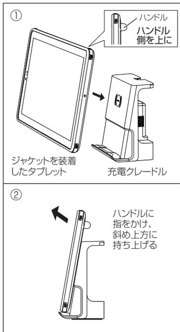
①本機後部のハンドルを上にして、背面の接点充電端子と充電クレードルの接点充電端子の位置が概ね合うように近づけると、磁力で引き寄せられ接合が完了します。接合が完了すると、充電が開始され、充電クレードルの電源ランプの色が青色に変わります。マグネットの磁力で接合状態を保ちます。
