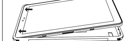
**電源供給コネクタがきちんと接続されていないとタブレットは充電されません。装着後、必ず充電クレードルに装着したタブレットの充電ランプが点灯していることを確認してください。**
