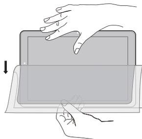
③透明剥離シートを手前側に引いてゆっくりはがしながら、フィルム本体を貼り付けていきます。少しずつ上からフィルム本体を押しさえ、できるだけ気泡をフィルムの外に逃がしながら進めていきます。貼ったあとに残った気泡は、指先でフィルムの端へ押し出します。
