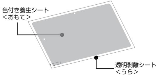
画面保護フィルムよりひとまわり大きいサイズの透明シートが剥離シート（裏面）です。剥離シートは画面保護フィルム本体裏面の粘着面をカバーしており、本体をタブレットへ貼付するときにはがします。
