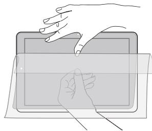
②画面保護フィルム本体に穴が開いている長辺側から、フィルム本体裏面の透明剥離シートを数cmだけはがし、はじめにフィルムの端と画面端の位置を合わせて上下位置を決めます。次にWebカメラ用開口とタブレットのカメラの位置を合わせて左右位置を決め、長辺の貼り付け位置を確定させます。
