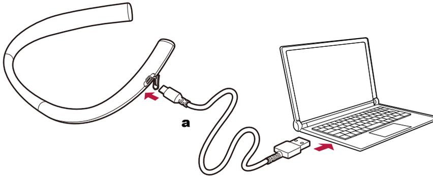
付属のTYPE-C USBケーブルを本機のUSBポートに接続し、もう一方のUSBプラグをパソコンのUSB端子に接続します。
