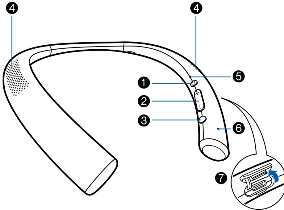
1. 〇 ボタン：電源をON/OFFしたり、ペアリング状態にします。（→[p8](#)）
